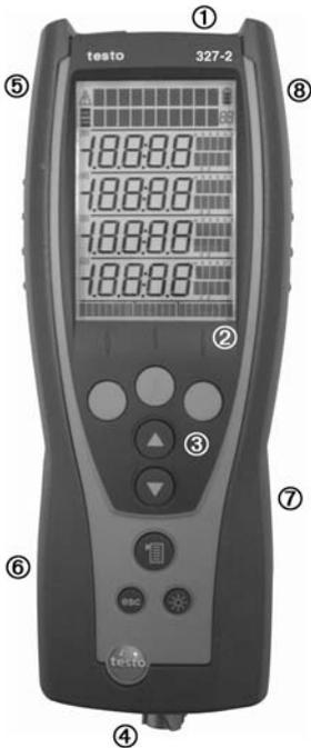
① Интерфейсы: IR (327-2: IRDA) для связи с Testo принтерами, кнопка Вкл/Выкл (⏻), слив конденсата.
